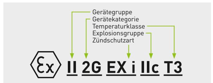
ABBILDUNG 3: BEISPIEL FÜR EINE EXPLOSIONSSCHUTZKENNZEICHNUNG
